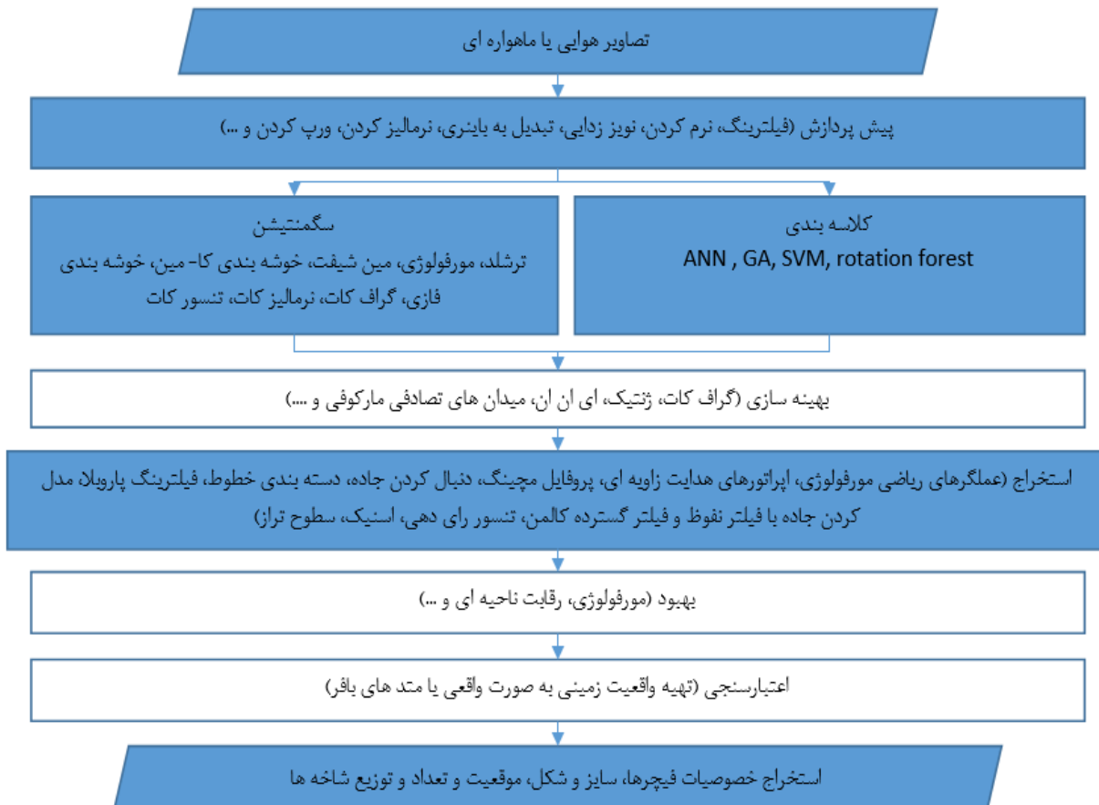
شکل ۲- روند پیشنهادی کلی شناسایی جاده در تصاویر سنجنش از دور
